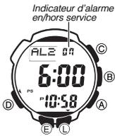
1. En mode Alarme, utilisez (A) et (C) pour faire défiler les écrans d'alarme jusqu'à ce que l'alarme dont vous voulez régler l'heure apparaisse.
