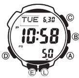
L'afficheur de la montre est éclairé pour être mieux visible à l'obscurité. Le commutateur d'éclairage automatique de la montre s'active lorsque vous tournez la montre vers votre visage, et à ce moment l'afficheur s'éclairc.
